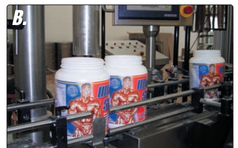
Bis heute werden nach wie vor alle Goldfield-Produkte in Deutschland produziert. Foto A: Pharma-Mischer mit 3.000 kg Kapazität, und B die automatische Abfüll-Anlage (Archiv-Bilder).
